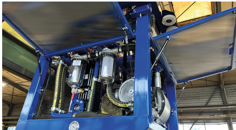
4 portes avec vérins pour maintenance simplifiée
