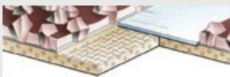
Typ 4: Joint bord à bord avec film de renfort côté grains
