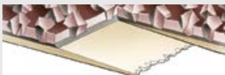
Typ 1: Joint à recouvrement sans enlèvement de grains
