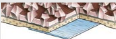
Typ 3: Joint bord à bord avec film de renfort au dos
