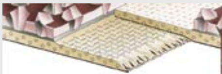
Typ 2: Joint à recouvrement avec enlèvement de grains
