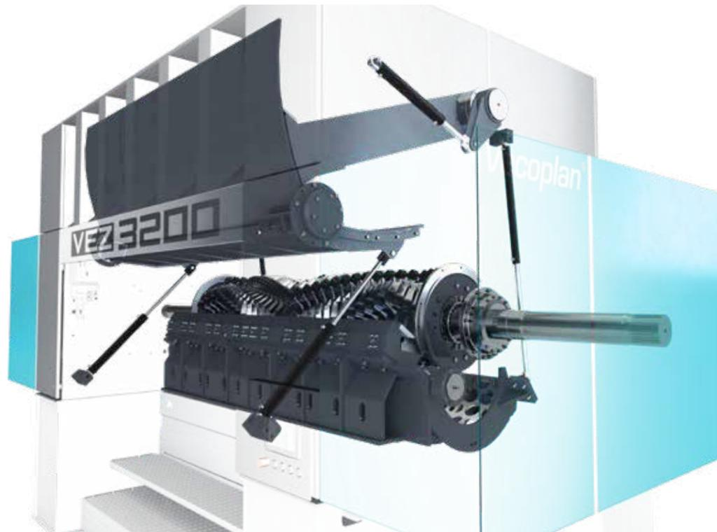
Si le broyage est trop difficile, en raison par exemple de grandes pièces métalliques, la détection des indésirables intervient et protège la machine. Grâce au clapet inférieur hydraulique, l'élément indésirable est retiré en un retiré rapidement. Cette opération ne génère qu'une courte immobilisation. Les pré-broyeurs à un mono-rotor peuvent être exploités de manière rentable, avec un débit élevé constant et une qualité homogène du produit.
