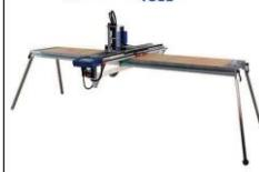
YETI TOOL: machine de fraisage démontable grande dimension
