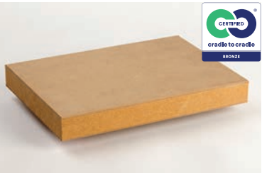
Finlight Panneau sandwich léger composé d'une âme de fibres de basse densité (350 kg / m³) et de faces en MDF mince de 3 mm pour applications intérieures en milieu sec.
