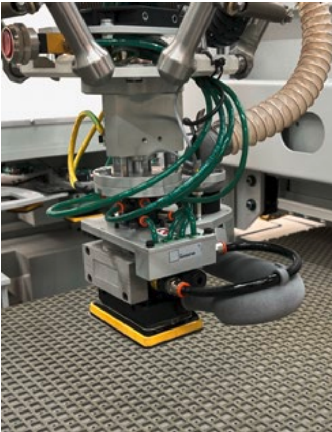
Outil de ponçage robotisé breveté
