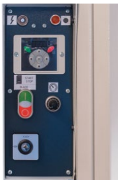
Regolazione elettronica di velocità della lama (inverter) - Optional Electronic blade speed adjustment (inverter) - Optional
