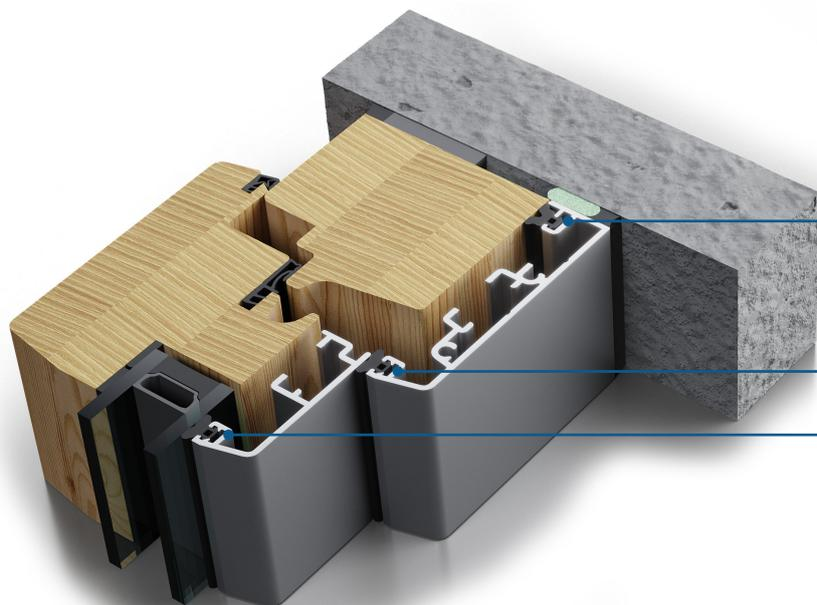
Pour faciliter les montages en atelier, un joint unique assure les 3 points d'étanchéité.
