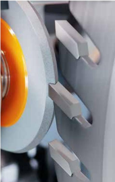
//////// USINAGE DE LA RAINURE V
