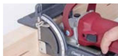
**Stabilité verticale** assurée par la butée fixée sur la plaque de base pour agrandir la surface d'appui
