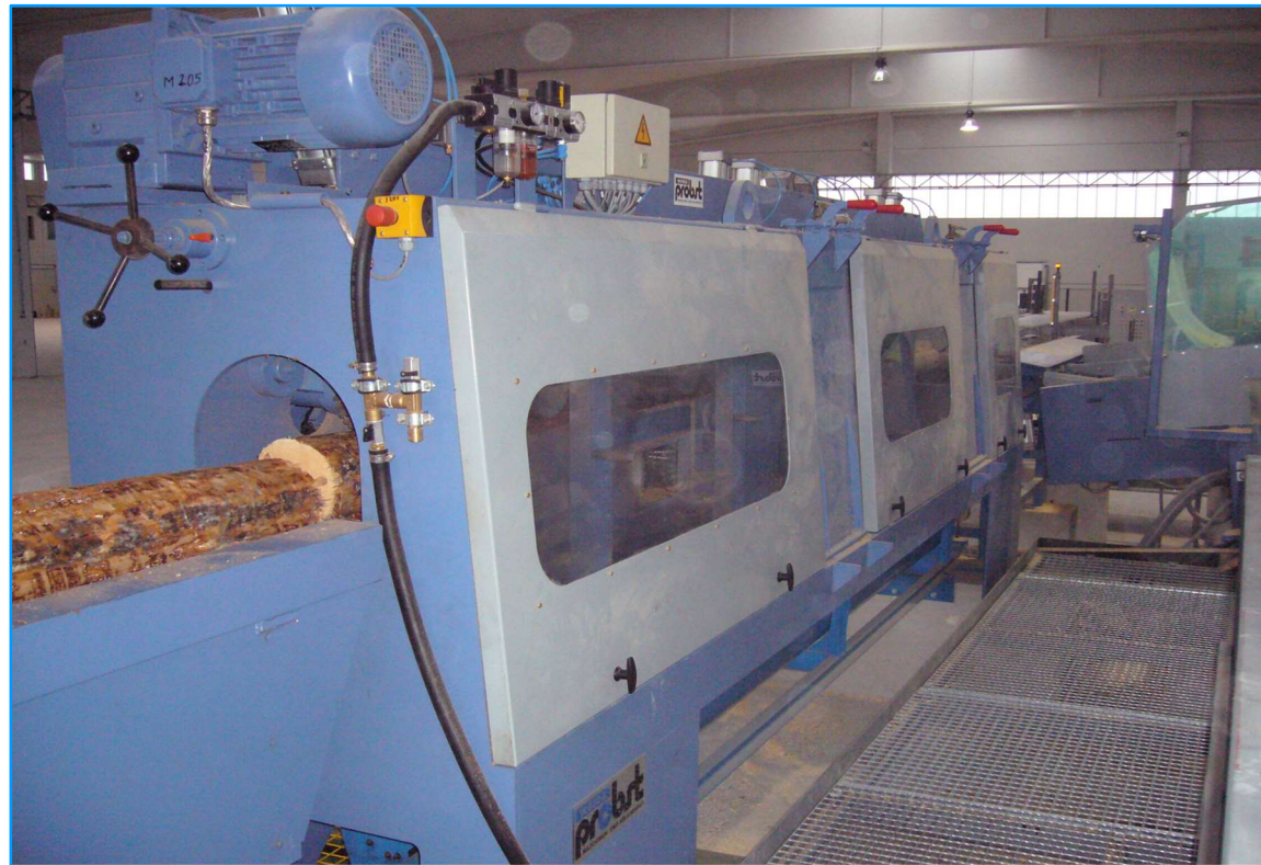
" Naturoptimierer " - Rundstabfräsmaschine " Nature optimizer" - Rod Rounding Machine " Optimisation" de la nature" - Machine à fraiser " Optimización natural" - Máquina cilindradora
