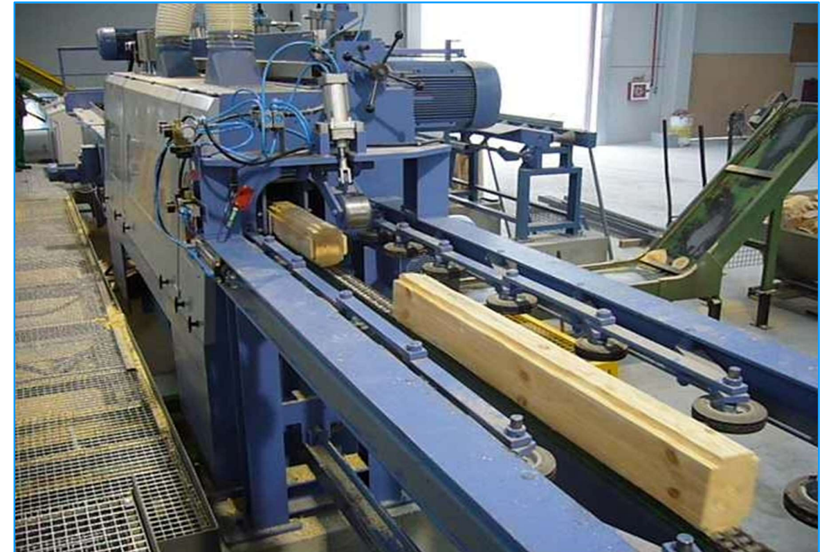
Profiler- und Sägemaschine Profiling and multiple sawing machine Machine de profilage et sciage Máquina de perfilado y múltiple
