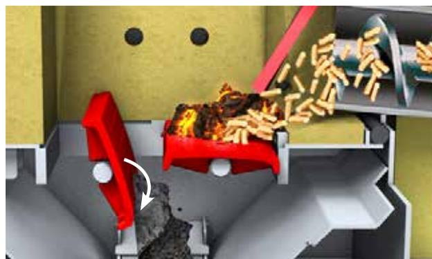
En fonctionnement, la chaudière effectue des **décendrages partiels** (seule la grille arrière pivote). Cela permet d'éliminer les cendres du foyer tout en conservant le lit de braise principal pour une combustion continue.
