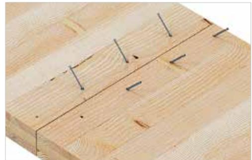
Liaison plancher CLT sur plancher CLT à l'aide de vis SWD croisées
