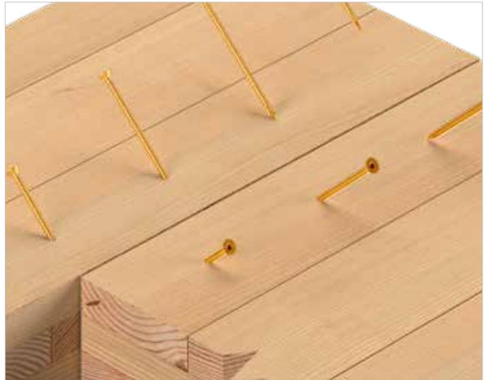
Assemblage de plancher CLT avec des vis ESCRFTC croisées
