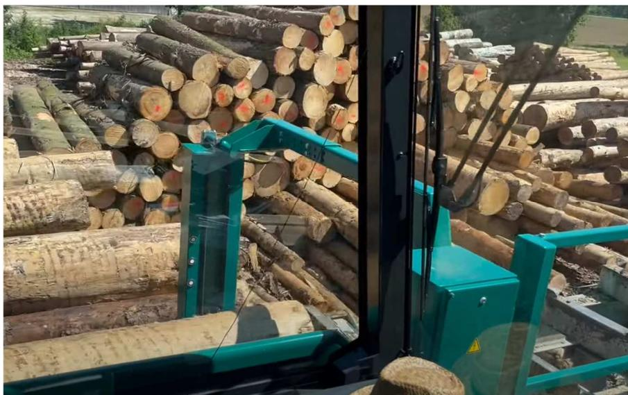
Le rendement de la scierie est déterminé dès la première étape, lors de la division avec le chariot de triage. C'est à ce moment-là que l'on détermine quel sciage et quelle grume seront utilisés pour la coupe du bois de sciage. Une division non optimale ne peut plus être corrigée lors des étapes de travail suivantes.
