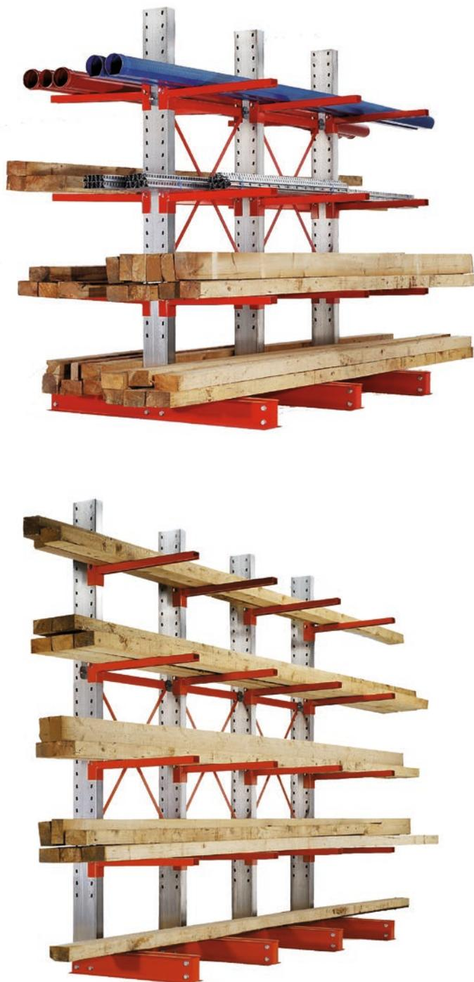
Un système Cantilever ELVEDI léger de type SL, approprié pour le stockage de panneaux, de tubes ou de profilés de toutes dimensions etc.
