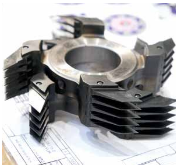
Theurl réalise ses assemblages par aboutage dans son usine de bois lamellé-collé sur le site de Steinfeld à l'aide de la fraise à abouter LEUCO Solid 34.
