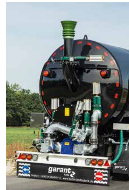
Cône de ravitaillement pour véhicule de transport (TSA) sur la partie supérieure de la paroi arrière de la cuve
