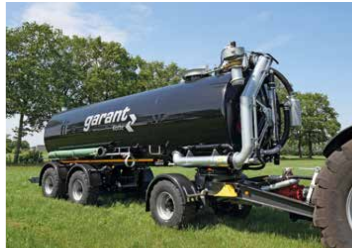
TAV avec bras de pompage double articulation et dôme de remplissage par le haut
