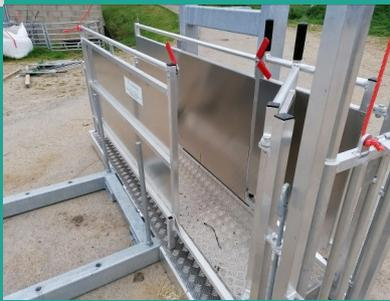
Il y plusieurs possibilités en ce qui concerne la pote de tri, on peut mettre sois en bout de couloir une porte de tri rapide arrière. Ou on peut inclure une ou 2 portes latéraux dans les claies pleines en combinant avec une porte guillotine. Pour avoir jusqu'à 3 voies.
