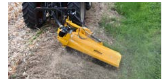
Beaucoup de place pour l'attelage sur le tracteur et l'arbre de transmission suiveur de mouvement.
