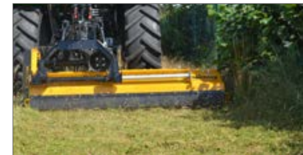
Déport latéral hydraulique : broyage déporté à côté du tracteur pour plus de flexibilité autour des arbres, des entrées ou autres obstacles (en option).
