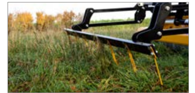
Sauveteur d'insectes : grâce à un étrier spécialement conçu, à repliage hydraulique, à dents coudées intégrées, les insectes et les micro-organismes sont chassés devant le broyeur et poussés à prendre la fuite. (en option pour des largeurs de travail de 2,0 m et 2,20 m)
