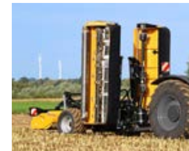
La position de travail et de transport ajustable hydrauliquement assure une hauteur de transport inférieure à 4 m.
