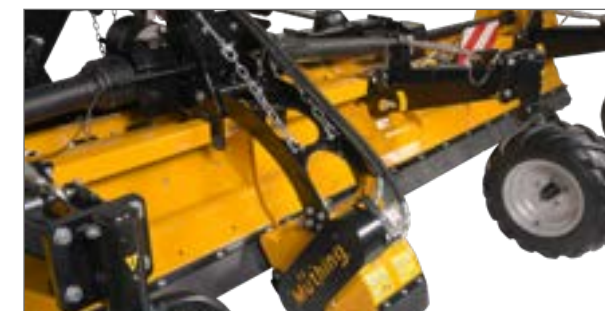
Broyeur de bande à entraînement hydraulique – Raccordements hydrauliques requis : 1 x conduite de pression avec connecteur BG 2, 1 x retour sans pression avec manchon BG 3, (en option)
