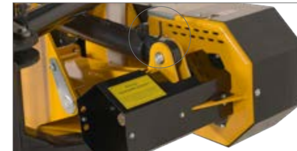
Sécurité de transport facilement verrouillable.
