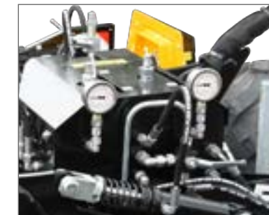
Idéal pour le rangement : système hydraulique de bord avec délestage de pression d'appui hydropneumatique MU-SOFA®.
