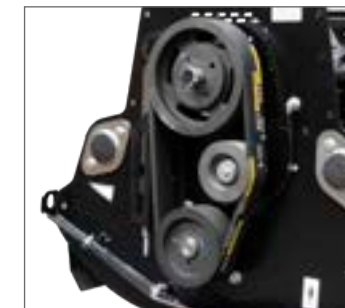
Travail sans encombre et nécessitant peu d'entretien grâce au tendeur automatique de courroie.
