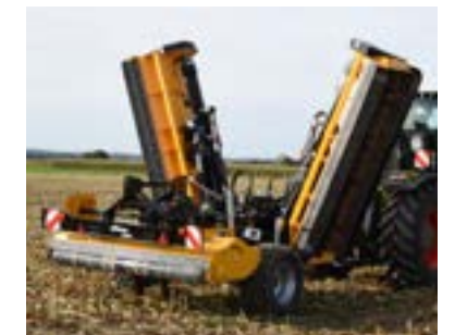
Repliage et dépliage rapides pour une largeur de transport inférieure à 3 m.
