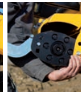
Réglage facile du rouleau d'appui orientable même sans aide supplémentaire.
