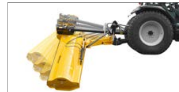
La sécurité anti-collision mécanique brevetée se déclenche de manière fiable et revient d'elle-même en position de travail.
