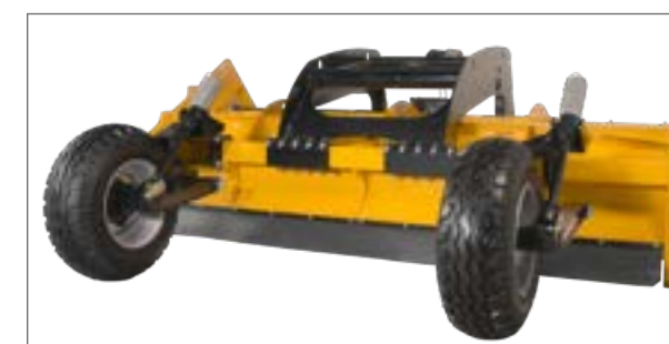
Roues de terrage qui préservent le sol pour le réglage en hauteur du MU-Farmer® en cas de montage arrière. Pivotant à 180° pour une grande maniabilité en bout de champ (tournière). Guide en profondeur sur route la largeur par le biais d'un grand rouleau d'appui sur le MU-Farmer® en cas de montage frontal.
