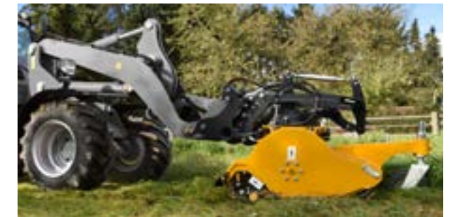
Un point de traction virtuel – Un brevet Mùthing : le broyeur est tracté avec une faible résistance au roulement au lieu d'être poussé, ce qui permet de suivre parfaitement le contour de sol en toute situation.
