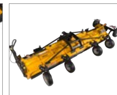
4 roues de terrage qui préservent le sol pour le réglage en hauteur du MU-Farmer® en cas de montage arrière. Pivotant à 180° pour une grande maniabilité en bout de champ (chaintre / tournière).
