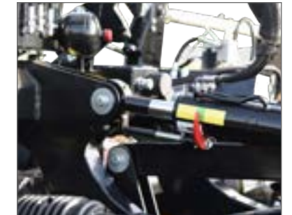
Sélection commode de la position de travail optimale facilitée par une indication bien visible.
