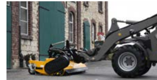
Pièces d'adaptation spécifiques au véhicule : le point de couplage abaissé assure une bonne vue d'ensemble grâce à la position oscillante abaissée. Bonne accessibilité pour les raccords hydrauliques.
