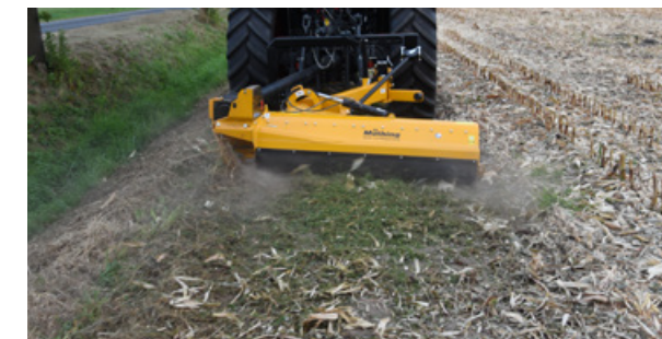
Une grande plage de pivotement permet de travailler tant à l'arrière que sur le côté du tracteur. Permet d'intervenir sur les voies d'accès étroites comme en bordure de champ.
