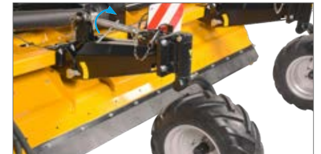
La barre de poussée permet de régler rapidement la hauteur de coupe qui convient.
