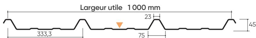
Longueur de profilage : Minimale 1 800 mm / Maximale 13 000 mm
