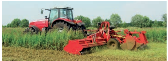
Version traînée, complète sur châssis porteur
