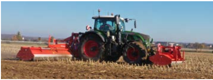
Version dissociée: broyeurs latéraux à l'arrière (Cat III) et broyeur central à l'avant
