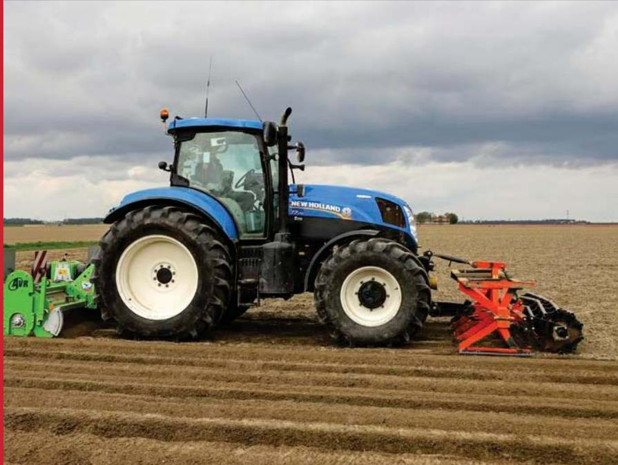
De nos jours, pour la plupart des types d'exploitation, le relevage et prise de force avant, font partie des équipements principaux du tracteur permettant d'améliorer sa polyvalence.
