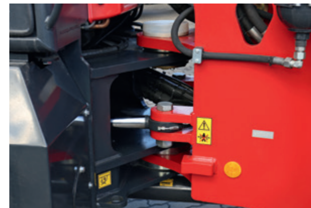
L'articulation centrale fortement dimensionnée est ultra solide et sans entretien. Les angles de braquage maximal permettent une excellente maniabilité.
