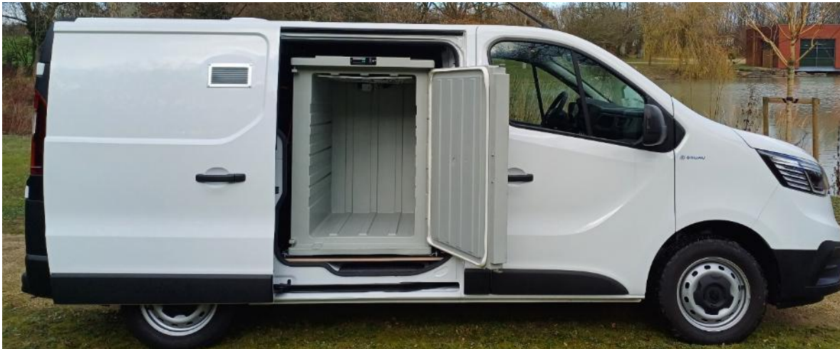
Accès du conteneur +3°C porte latérale
