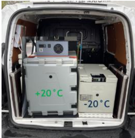
Accès des conteneurs +20°C et -20°C par les Portes arrière
