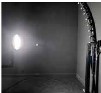
Grâce à notre photogoniomètre dont est équipé notre laboratoire, nous pouvons immédiatement mesurer les caractéristiques photométriques des luminaires, y compris celles des fabrications spéciales.
