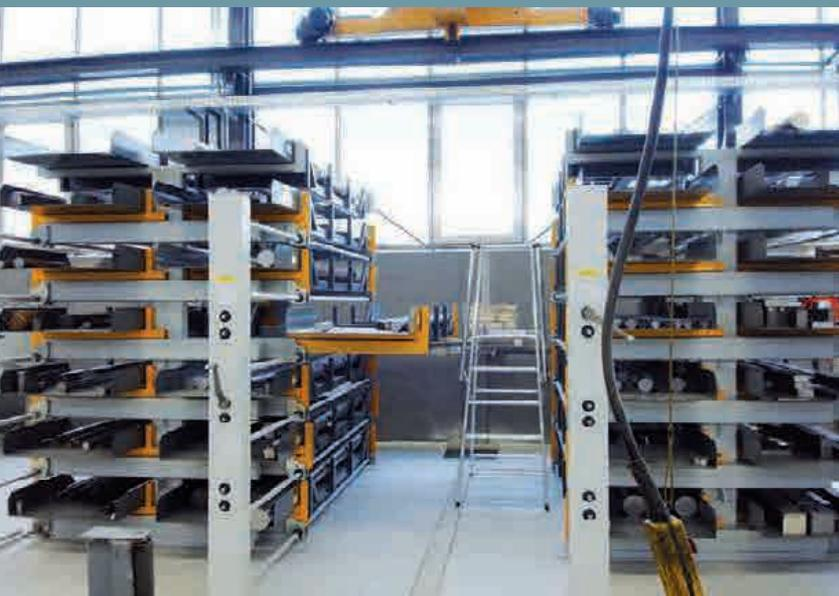
Au niveau des rayonnages à bras portants télescopiques, des niveaux de stockage entiers sont déplacés avec une manivelle via des broches rotatives. Idéal pour une manutention par grue dans une largeur d'allée réduite.
