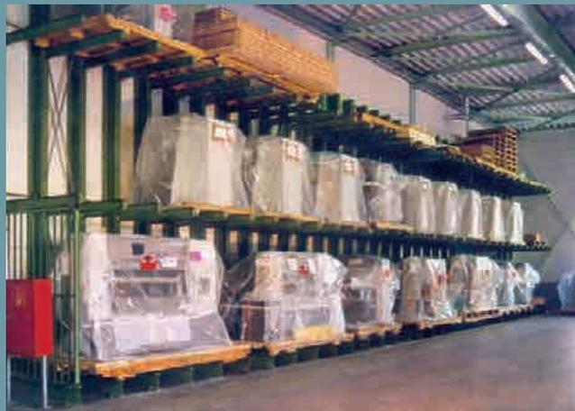
Les produits, prêts à être expédiés, sont rangés avec un gain de place sur les rayonnages à bras portants jusqu'au moment du chargement dans la zone sortie de marchandises.
