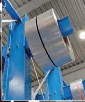
Les rayonnages à bras portants OHRA sont conçus et fabriqués en solution individuelle pour tous types de stockage dans le secteur de la métallurgie. Système idéal pour le stockage d'outils lourds ou de bobines en acier
