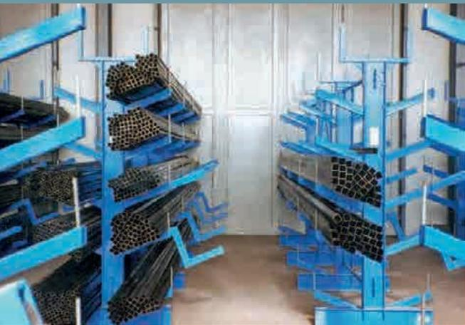
Rayonnages à bras portants pour un stockage de marchandises par pont roulant. Manutention grâce à des tubes de préparation de commandes ou des tubes de mise en stockage
