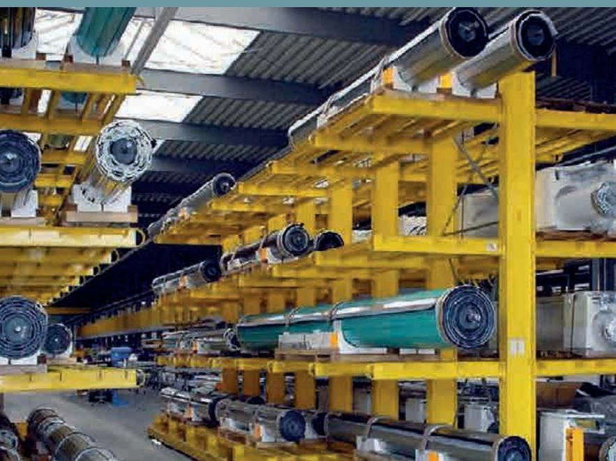
Portails roulants sur des rayonnages robustes à bras portants. Traverses entre les bras de support pour le stockage de marchandises de différentes dimensions.
