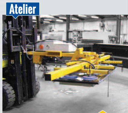
Palonnier sur fourche avec retournement motorisé pour panneaux composite
