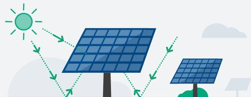
\* Les cellules solaires captent à la fois la lumière du soleil sur la face avant et arrière des panneaux photovoltaïques par réflexion du sol et de son environnement.
