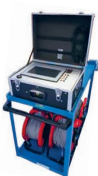
Banc de test pour vérification de capteurs de freinage en transport ferroviaire
