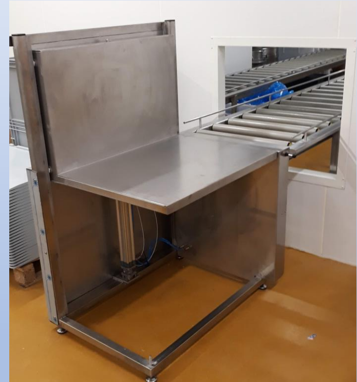
Fabrication et mise en place d'une table élévatrice en inox.
