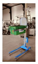
Petit et très maniable, le chariot Lift & Drive Semi-pro permet de soulager le dos et les épaules des opérateurs lors des manipulations de charges légères et répétitives jusqu'à
