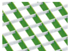
**Barres insérantes (BI) (ou transversales / entretoises) :** insérées perpendiculairement dans les barres porteuses (par pressage pour le caillebotis pressé sous forme de « fer plat » ou par électrosoudage pour le caillebotis électroforé avec une section en « carré torsadé »), elles garantissent le maintien des barreaux porteurs.
