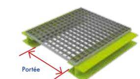
**Étanchéité – Maille de sécurité :** la maille de sécurité correspond aux configurations de maille suivantes : 30 x 19 ; 19 x 30 ; 19 x 19 ; etc. Elle est conseillée en milieu industriel (Norme 14122) et est étanche à une bille de 20 mm de diamètre.
