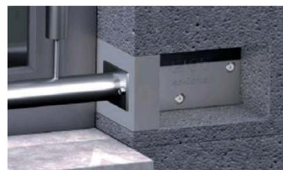
3 - Fixer l'élément avec les vis Ø 10 mm (trou Ø 8 mm)
