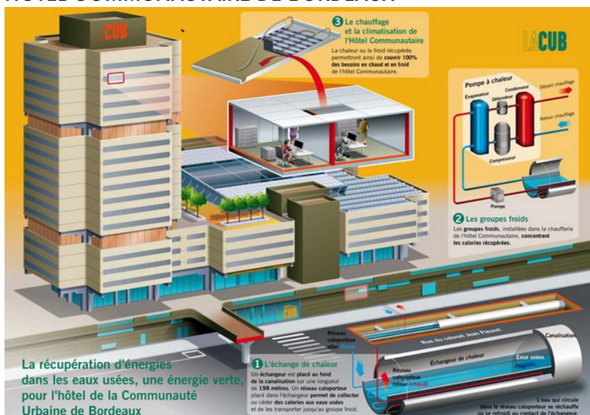
Installation pour une puissance fournie de **800 kW** réalisée avec LYONNAISE DES EAUX
