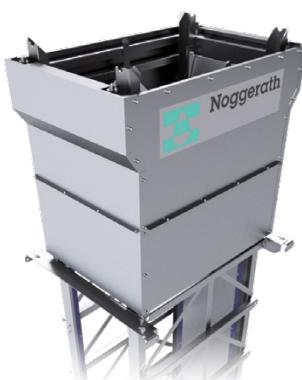
Châssis de conception épurée et très résistante. La conception modulaire permet d'optimiser la hauteur du Centre-Flo™ et la largeur du dégrilleur en fonction des exigences du canal, de la capacité et de la perte de charge. Système de capotage modulaire amélioré et léger. Des profondeurs de canaux allant jusqu'à 10 m sont possibles avec la conception standard (des canaux plus profonds sont possibles en option).
