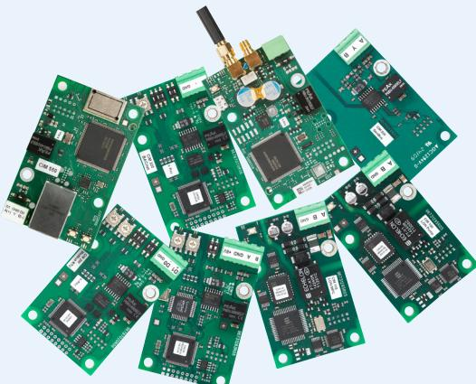
Le concept Grundfos Fieldbus est la solution idéale pour un contrôle complet des pompes et systèmes de pompage. Le Module Interface de Communication (CIM) et l'Unité Interface de Communication (CIU) permettent la transmission de données par l'intermédiaire de réseaux ouverts et interopérables.
