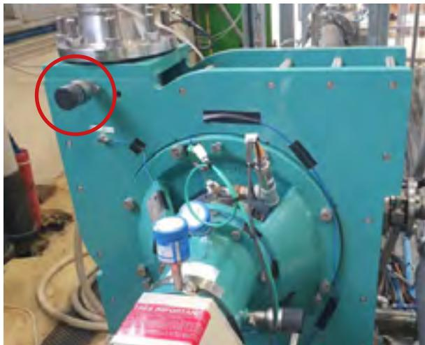
Capteurs de vibrations et de température
