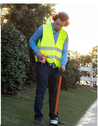
Corrélation acoustique et écoute électro-acoustique : **SeCorrPhon AC 200 GNSS**
