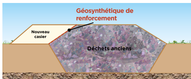
Extension latérale, en appui sur le flanc d'un casier existant et sur le substratum
