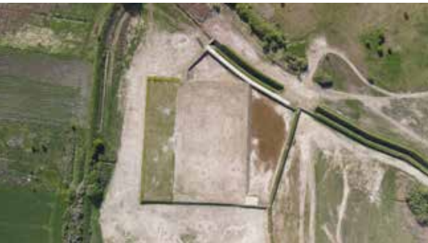
9100M 3 - PRUSZCZ GDANSKI En zone péri-urbaine, deux couches de blocs alvéolaires nidadplast ont été installées pour réaliser certainement l'un des plus grands bassins de rétention des eaux pluviales dans le monde, en 2023.
