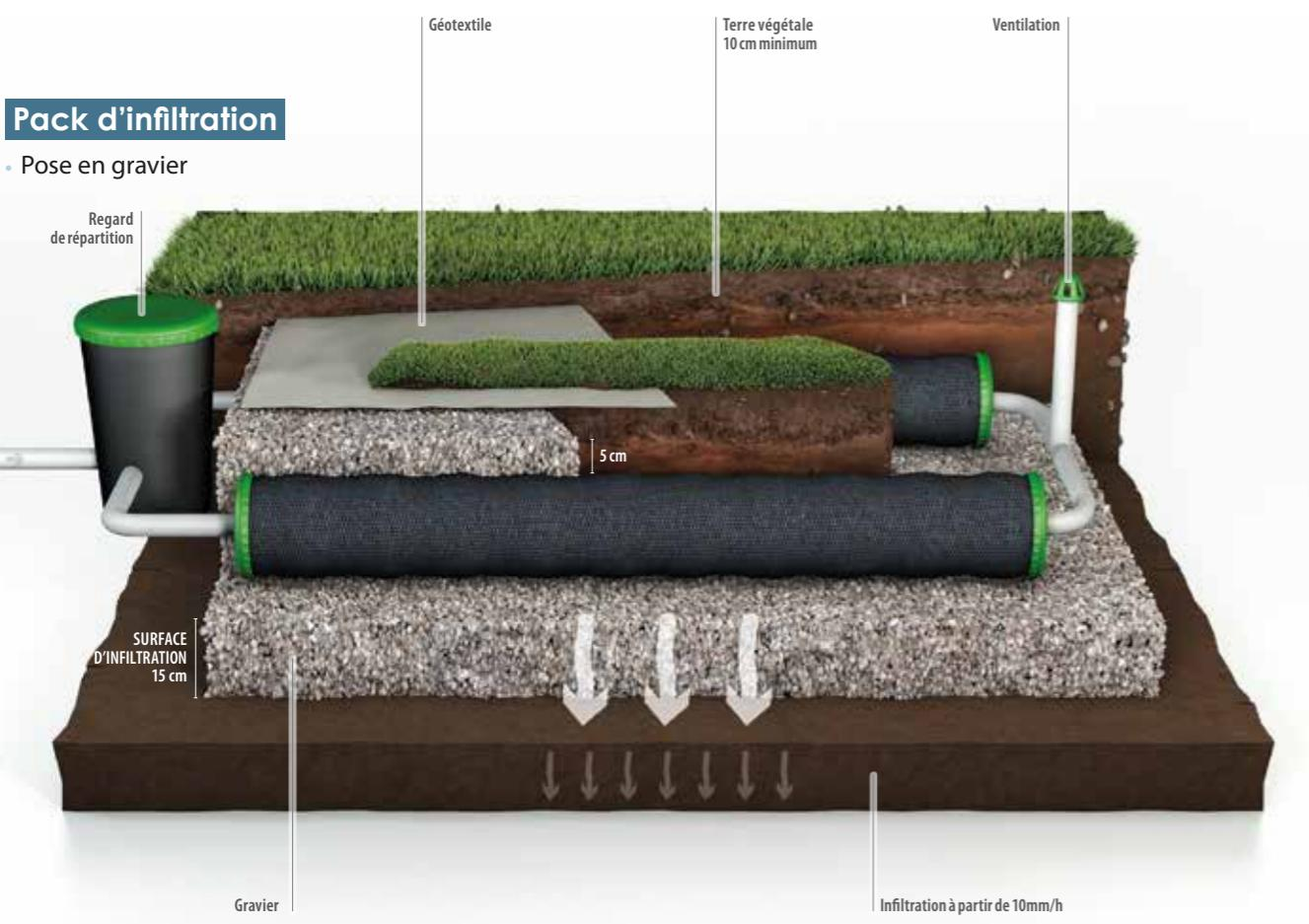
PITT : Pack d'Infiltration et de Traitement Tertiaire
