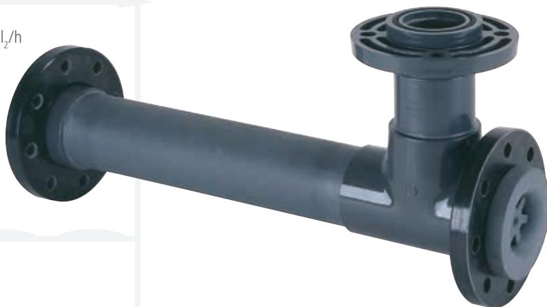
En cas d'interruption de l'alimentation en eau motrice de l'hydro-injecteur, la pression complète de l'eau motrice est présente à la tubulure d'aspiration de l'injecteur. Les clapets anti-retour de l'hydro-injecteur empêchent l'eau de pénétrer dans la conduite de vide de l'installation de chlore gazeux.
