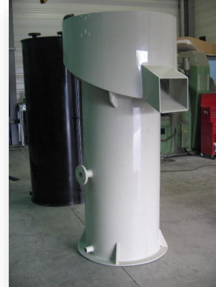
En PPH Décanteur cylindro- conique – Surverse simple OPTIONS :
