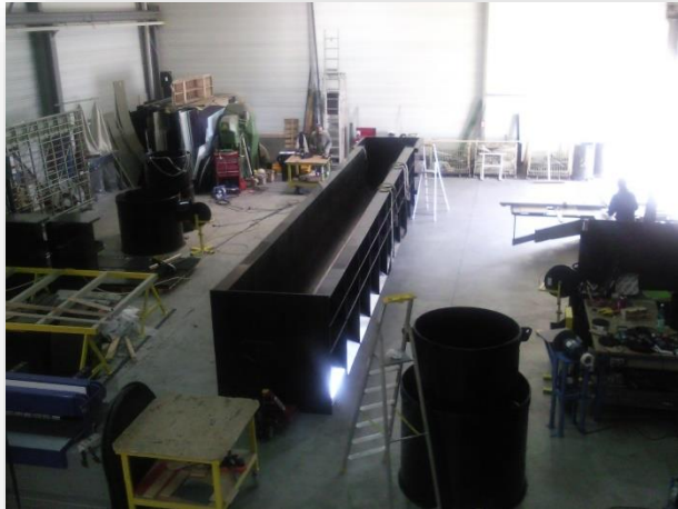
Cuve de rinçage de tube Inox 12m Bac 1/2 cylindrique
