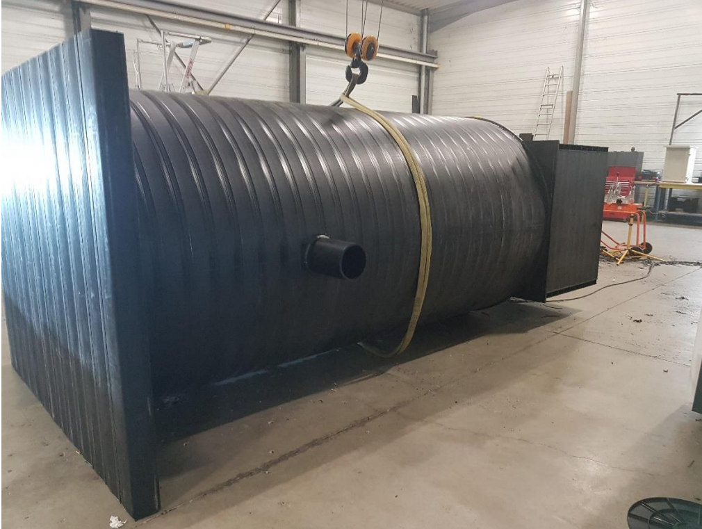
Poste de relevage Ø1600 / 3000mm, tube et fond alvéolaire
