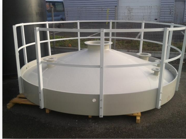
Couvercle PPH et garde corps SVR pour rajout sur cuve ouverte PPH
