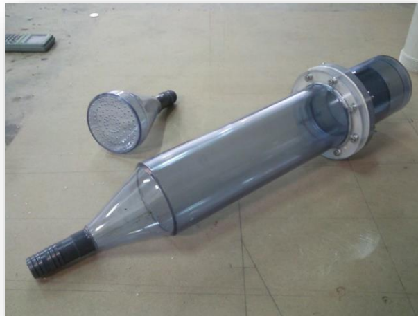
Mousoir en PVC (agroalimentaire protection graine de maïs)
