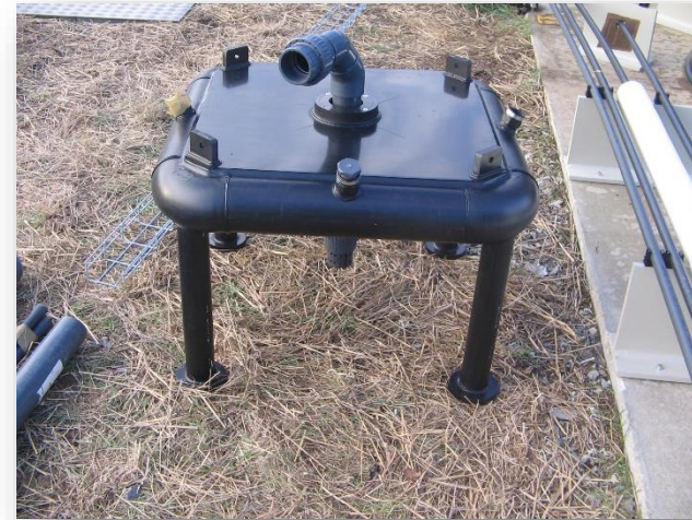
Radeau PEHD pour pompage dans bassin de stockage effluents
