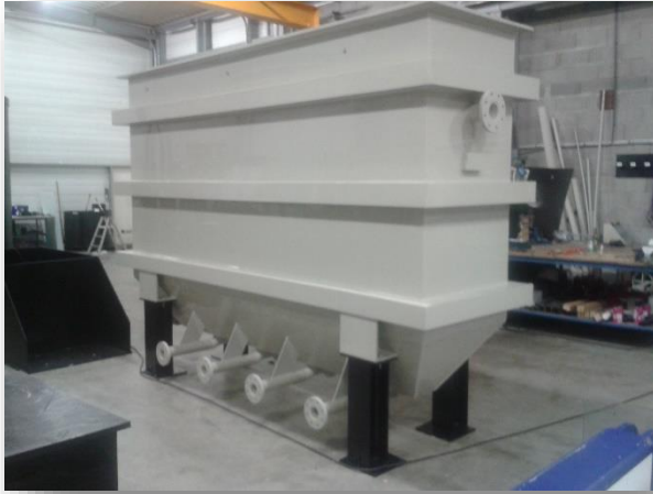
En PPH – Décanteur Lamellaire (système de lamelles par insertion d'un bloc inox)
