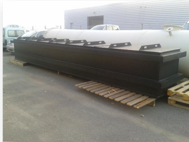
Bac de traitement de surface (profilés) 7000x1200 ht 1000
