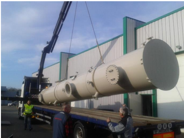
Tour PPH de lavage de gaz 3 étages Ø 1600 ht 13m
