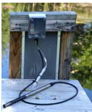
La ProSwap Logger est une sonde à port unique et à prix abordable pour ceux qui souhaitent suivre en temps réel les paramètres de la qualité de l'eau.
