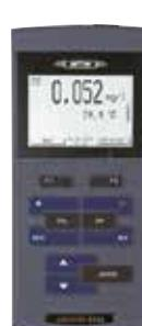
Appareil de poche pH/ISE pour des mesures de pH, mV et de concentration.
