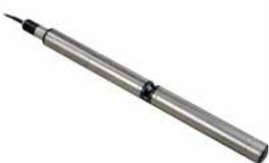
UV 700 IQ SAC : sonde économique (système de nettoyage à ultrasons intégré, compensation de turbidité) pour la mesure SAC sans entretien et sans réactif selon DIN 38404 C3.
