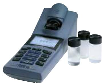
Mesure mobile néphélométrique de la turbidité de très haute précision selon DIN ISO / US EPA pour l'analyse de l'eau, le contrôle de qualité et la surveillance des processus.
