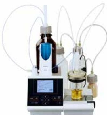
Le TitroLine® 7500 KF est un équipement volumétrique généraliste pour la détermination de la teneur en eau avec un large choix d'utilisations.
