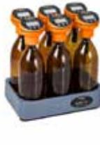
OxiTop®-IDS (système de mesure : tête de mesure, flacon d'échantillon, agitateur, contrôleur)
