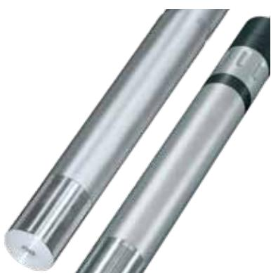
VisoTurb® : sondes optiques de mesure de la turbidité selon le principe néphéломétrique conformément aux normes DIN EN 27027 et ISO 7027 pour une utilisation in situ dans l'eau/les stations d'épuration avec système de nettoyage à ultrasons.
