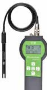
L'appareil LF 40 combine les caractéristiques d'une application mobile sur le terrain avec la précision et le confort d'un appareil de laboratoire grâce à un menu présenté en texte clair, un système d'enregistrement de données intégré et un boîtier IP 65 robuste et étanche à l'eau. Le LF 40 est doté d'une compensation de température automatique pour la mesure de conductivité ainsi que d'une température de référence réglable avec des mesures sans capteur de température.
