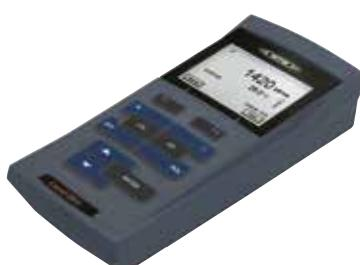
Le modèle polyvalent Cond 3310 est conçu pour des mesures de conductivité dans des milieux changeants avec différentes cellules de mesure à 2 et 4 pôles.
