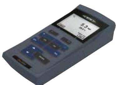
La série Oxi 3000 : solution portable très simple, robuste et étanche, pour la mesure de l'oxygène dissous dans les eaux de surface, les stations d'épuration et les applications de pisciculture. Elle est adaptée aux sondes à oxygène galvanique CellOx® et DurOx®, mesure de pression partielle, concentration et saturation. Correction de salinité.
