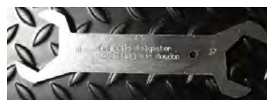
Clef en acier galvanisée serrage des raccords PEHD
