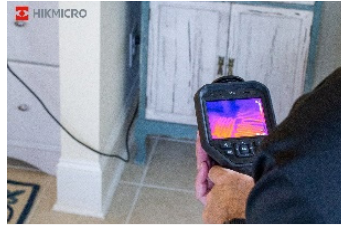
Vérification de plancher chauffant
