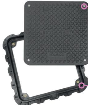
Système de verrouillage par **quatre vis** en acier inox à tête cylindrique fendue et écrou laiton noyé dans le cadre
