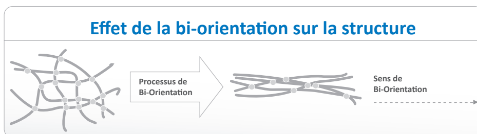
Quand le PVC de structure amorphe (section inférieure) est soumis au processus de bi-orientation, on a comme résultat une structure laminaire (section supérieure).
