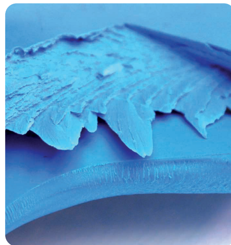
Quand le PVC de structure amorphe (section inférieure) est soumis au processus de bi-orientation, on a comme résultat une structure laminaire (section supérieure).
