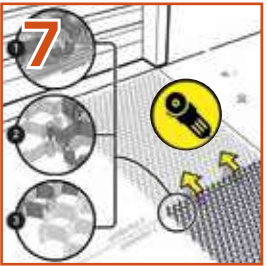
Découpe si nécessaire, et pose d'Alveplac®.
