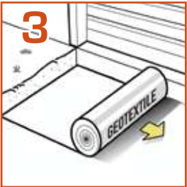
Mise en place du géotextile et réalisation des bordures de la zone si nécessaire.
