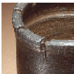
FISSURES DANS LES SEGMENTS
