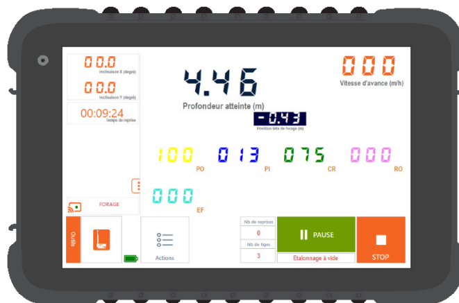
Enregistrement de l'Essai de Chute Libre (ECL) sur la longueur du forage
